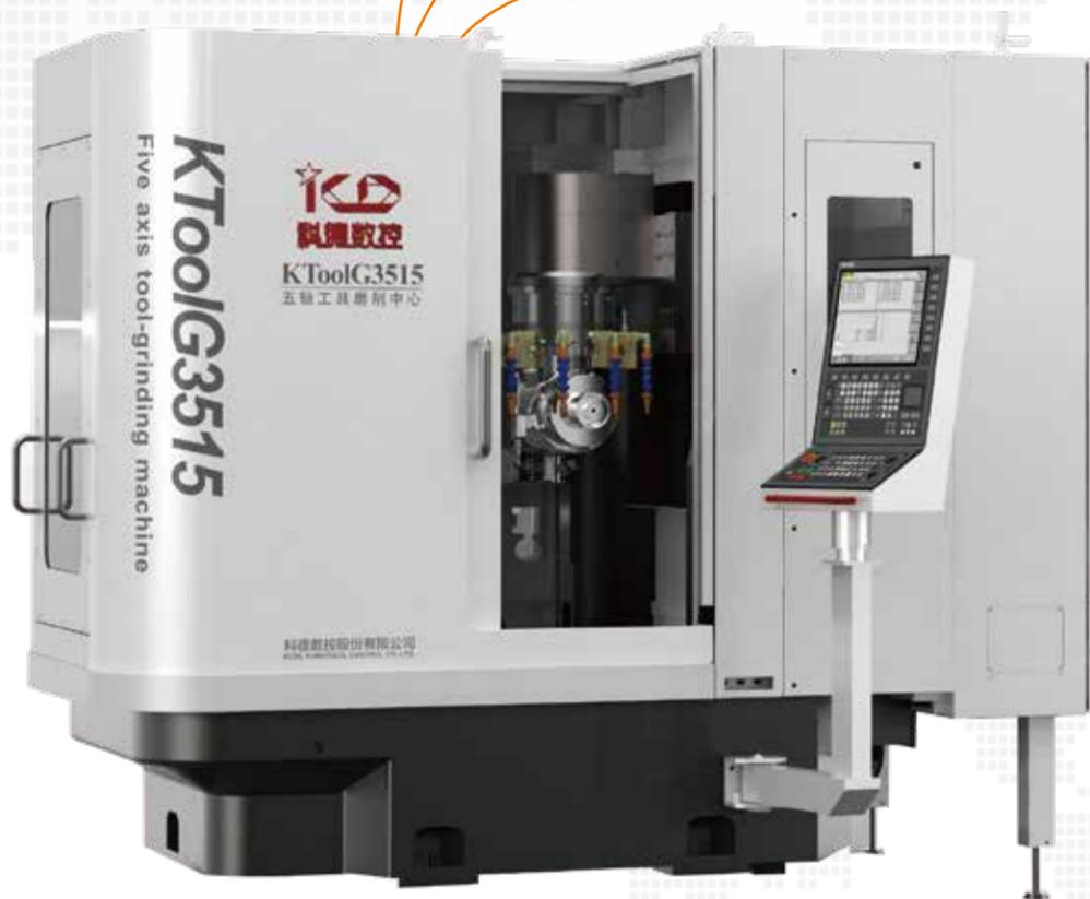
+ KToolG 3515机床的X/Y/Z轴和A/C轴均为全闭环控制。本机床适用于各种铣刀、钻头、铰刀、丝锥等精度高，形状复杂刀具的加工。本机型中所采用的数控系统、智能电源及伺服驱动器、伺服电机、力矩电机、主轴电机以及电主轴全部由科德数控股份有限公司提供
